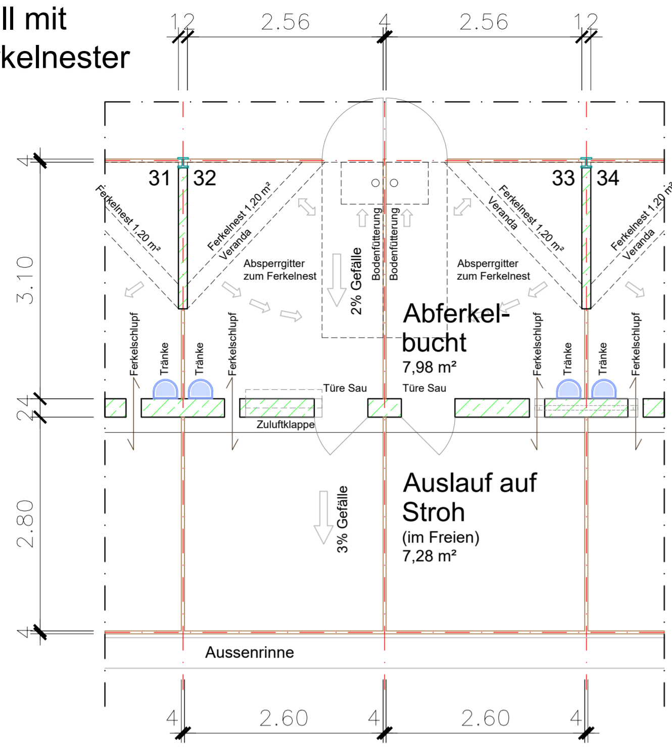
Abferkelstall mit Rechteckferkelneuer M 1:50
