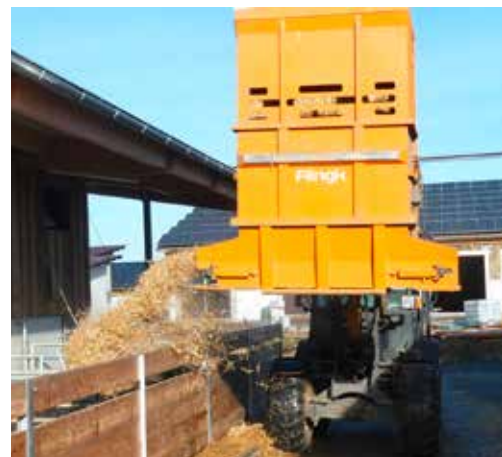
Das Einstreugerät der Fa. Flingk kann auf einem Hoftrac montiert werden.
