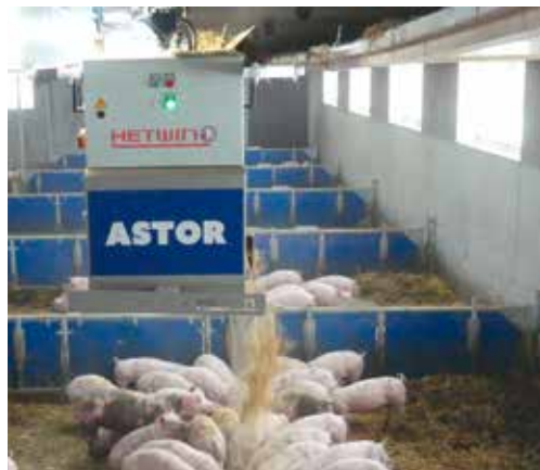
Robotergeräte ermöglichen die automatisierte Ausbringung von Einstreu oder anderem Futter.
