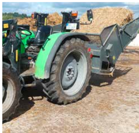
Vorne Mistschieben, hinten das Einstreugerät, im Bild ein Fabrikat der Fa. Mehrtens.
